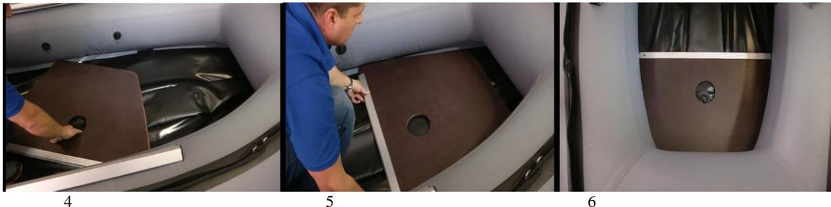
5. Поворачиваем на 90 градусов и двигаем к носу лодки до упора.
