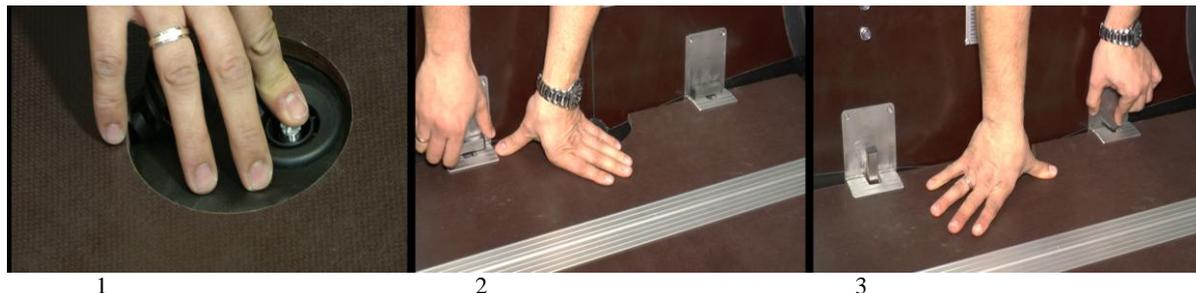
1. Спускаем воздух из киля, через специальный клапан.
