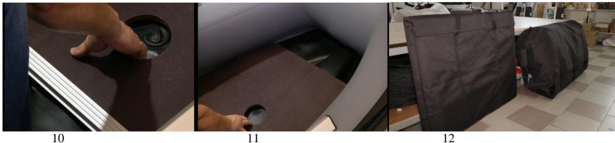
12. Разборка пола лодки завершена, остается очистить все элементы пола от возможных загрязнений и уложить их в специальную сумку для переноски, также не забудьте помыть саму лодку и протереть её насухо перед укладкой в транспортировочный чехол.
